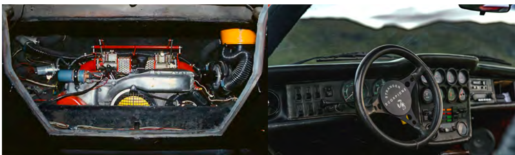
Motoren i Scorpionen nå er den sjette i bilen. Den første var understellets opprinnelige motor fra 1959. Nå har den en spesialtrimmet versjon på 2,4 liter basert på blokken fra VW 412. Dashbordet er typisk 1970-talls, med svært mange instrumenter og brytere. Man skulle ha god tilgang til alle slags kontroller. (Foto til venstre: Einar Stranden, til høyre: Franco-André Nilsen)
