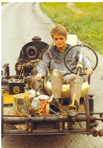
Bensintanken under testturene var et 10-liters spann, med en enliters malingsboks som reserve-tank. Ikke akkurat etter dagens sikkerhetsstandarder, reflekterer Stranden i dag. (Foto: Kolbjørn Ringstad)
